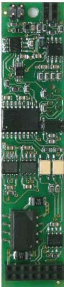
Мезонин-модуль MPRX предназначен для измерения частоты вращения вала турбины и других вращающихся тел.
