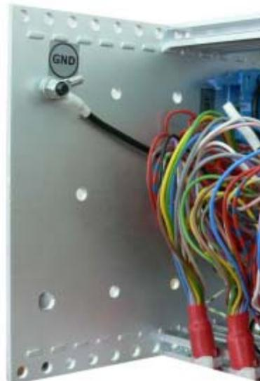
Рисунок 4 - Расположение болта логического заземления
